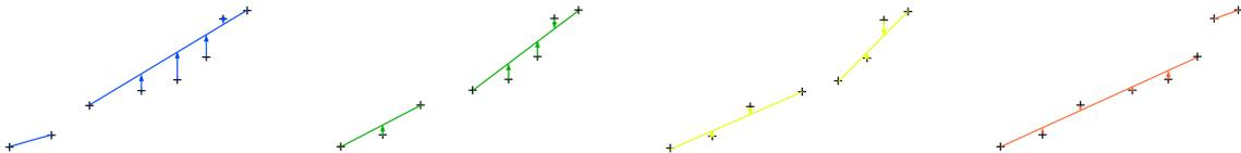
**Figure 4** – Méthode d'approximation par deux segments de droites. On considère les différents cas possibles et on choisit le cas minimisant l'erreur.
